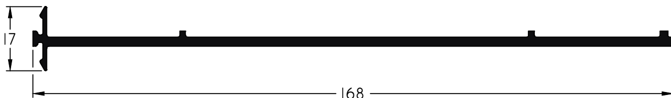
701 - Acople 3 guías Largo Std.: 6150 mm peso: 1,16 Kg/m
