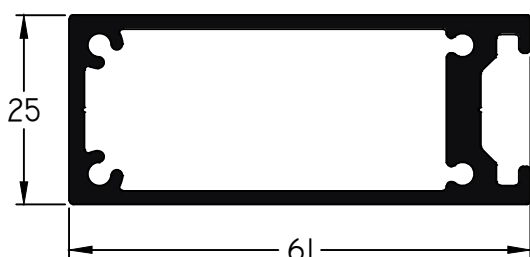
998 - Refuerzo inercial 61 mm Largo Std.: 6150 mm peso: 1,08 Kg/m
