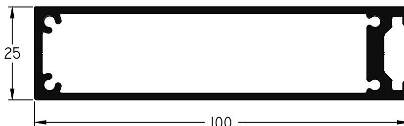
999 - Refuerzo inercial 100 mm Largo Std.: 6150 mm peso: 1,45 Kg/m
