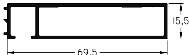
840 - Premarco de 69.5 mm Largo std.: 6150 mm Peso: 0,63 Kg/m
