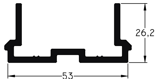
600 - Base Inercial M-Siete peso: 0,80 Kg/m
