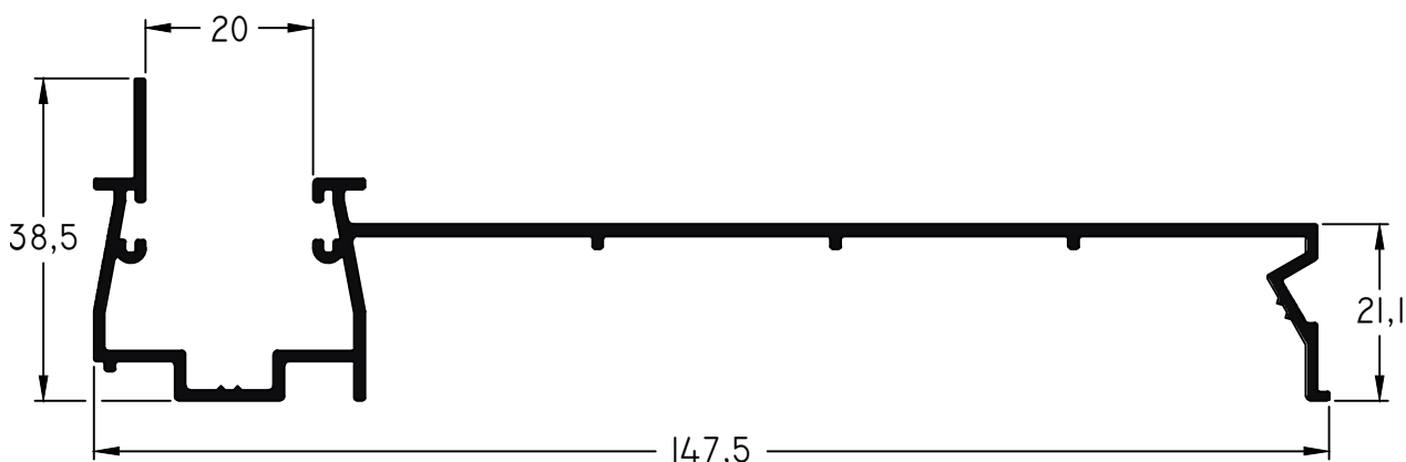
154 - Guía de Cortina Regulable (Tipo Barrio) Largo std.: 6150 mm peso: 1,02 Kg/m
