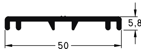
520 - Tapa de Policarbonato peso: 0,39 Kg/m
