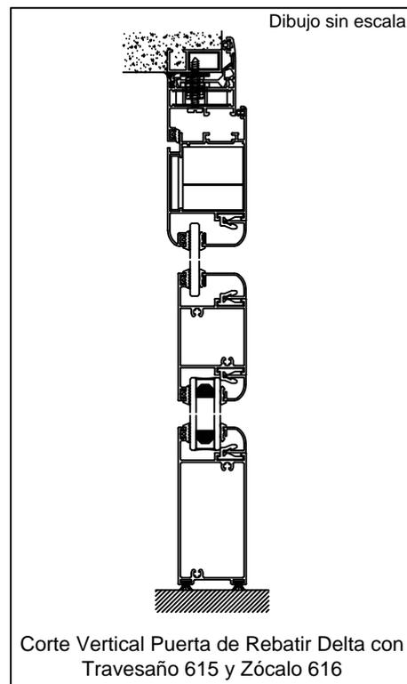
Corte Vertical Puerta de Rebatir Delta con Travesaño 615 y Zócalo 616
